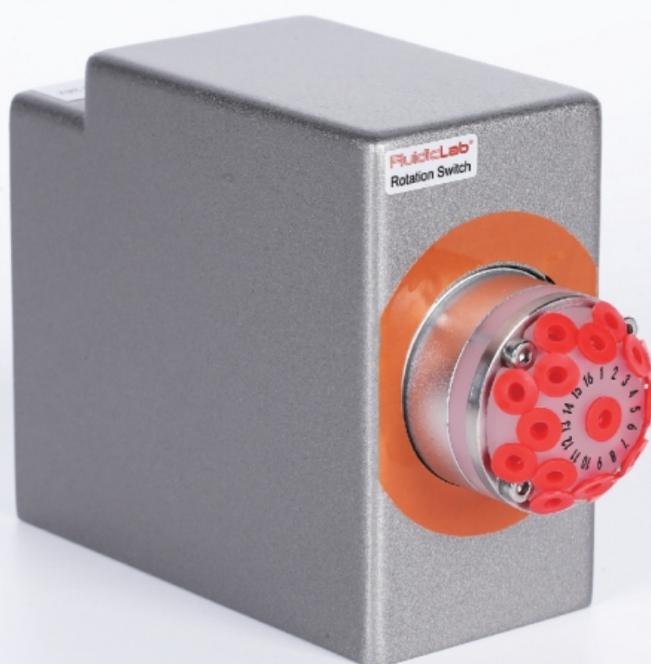
旋转切换阀可以作为液路选择器，将一种样品注入 16 条不同的液路中，或者将 16 种样品依此注入到同一液路中。
