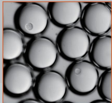
自动生成两相微滴，微滴直径从 20-250  $\mu\text{m}$ 。
